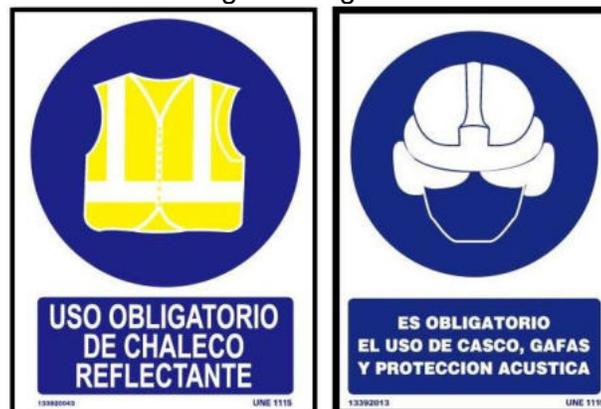
Figura 9. Ejemplos de señales para uso de equipos de protección dentro de la construcción
