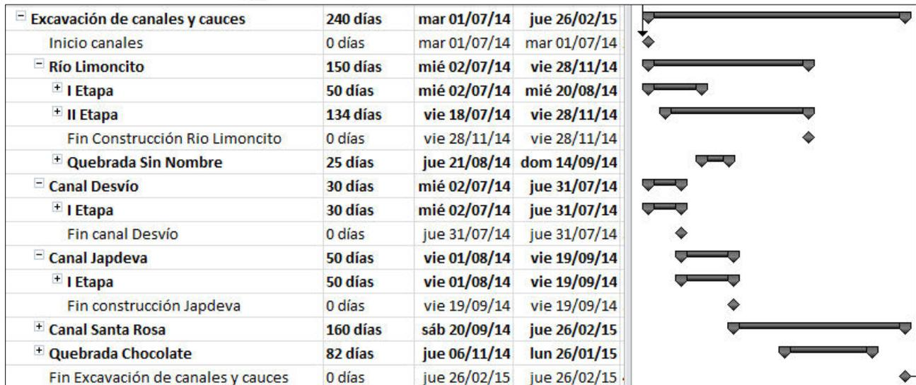
**Imagen 2.3.3 Duración e intercalación de las obras de excavación de canales y cauces.**
