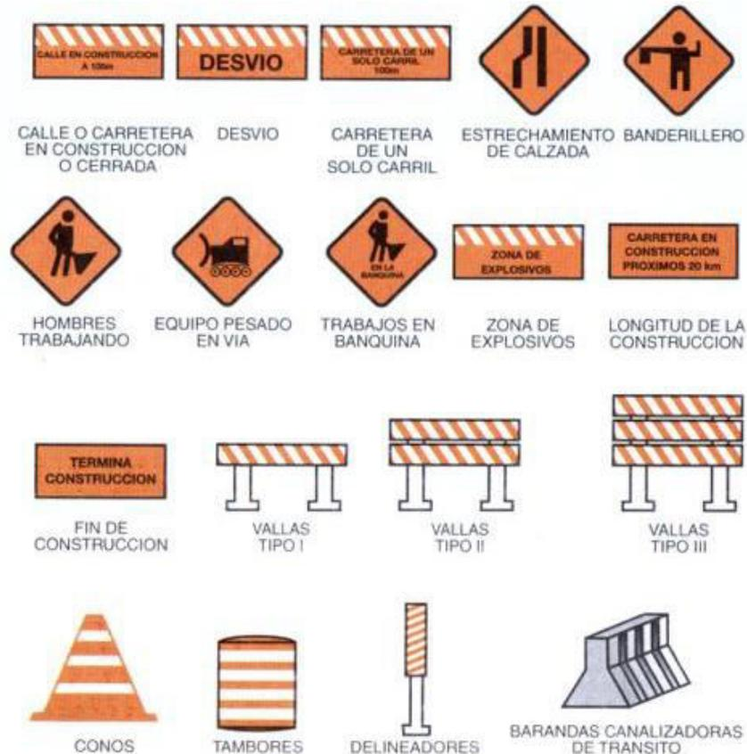
Figura 2. Ejemplo de señal para indicar equipo pesado en la vía
