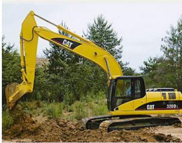
**Imagen 3.5-3** Excavadora Caterpillar 320 con cabina antivuelco cerrada
