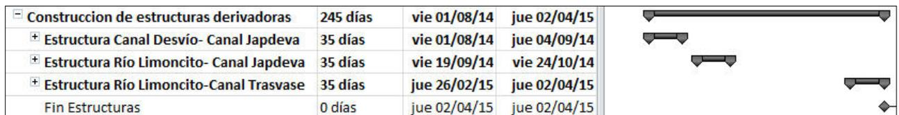
**Imagen 2.3.4 Duración de las estructuras derivadoras de caudal.**
