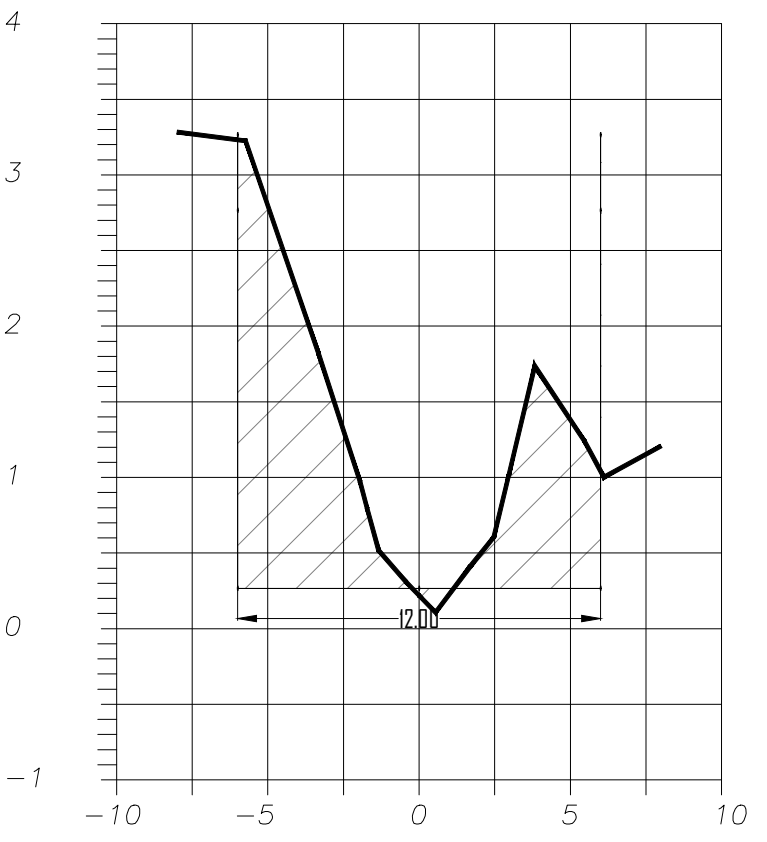
VOLUMEN 178.76m³ / AREA 12.14 m² SECCION 0+945 VOL_ACUM 13372.10M³
