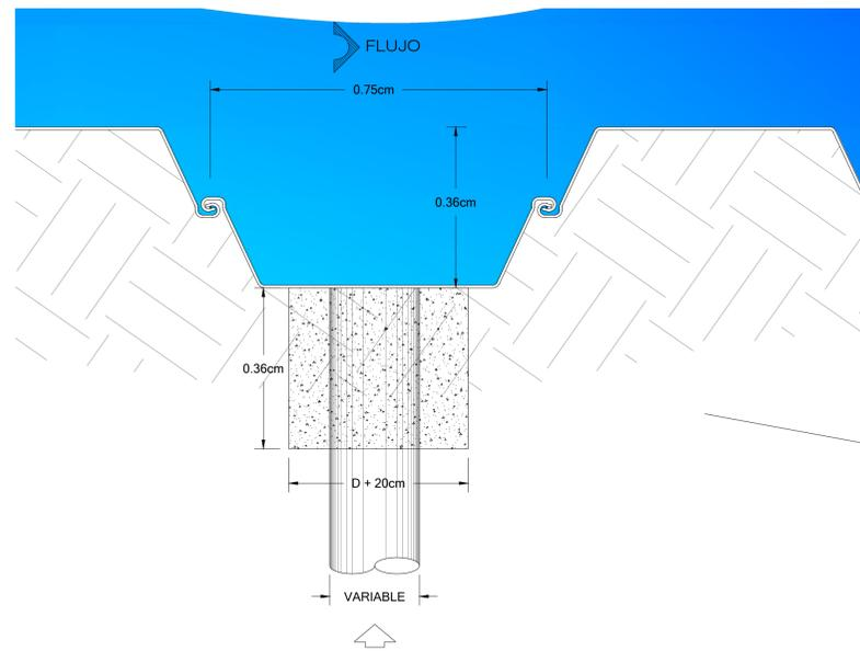
DETALLE TIPICO EN PLANTA DE SALIDA DE ALCANTARILLA EN TABLESTACA
